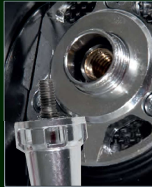
Achse aus Edelstahl und Antriebswelle aus Messing
